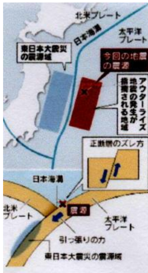
（資料5）アウターライズ地震の仕組み
